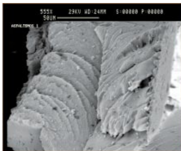
Figura 2a. Microfotografía electrónica de asfaltenos obtenidos a partir de crudo Castilla
